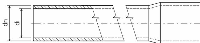
**Description:** conduit rigide tulipé conforme à l'essai de résistance à la propagation des flammes
